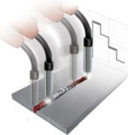
Permet de régler la valeur de la vitesse du fil au cours de la phase de fermeture de la soudeuse.
